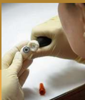
Mit speziellem Werkzeug wird eine Augenschale poliert. Foto: Elisa Todisco
